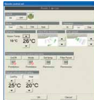
Bedienmenü für Betriebsart, Raumtemperaturen, Lüfterstufen, u.v.m.
