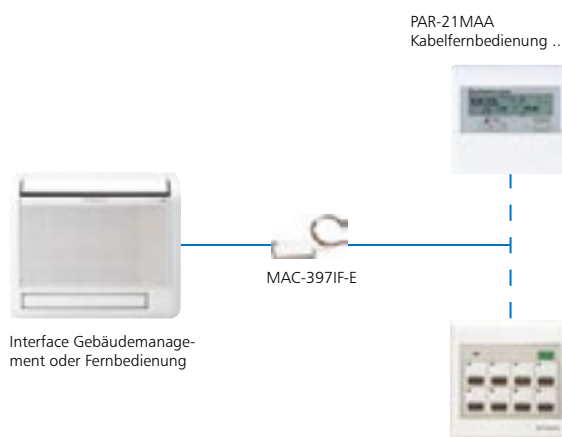
... oder MAC-821SC-E EIN/AUS Gruppenfernbedienung zur Unterputzmontage für bis zu 8 Innengeräte (separate Spannungsversorgung 230 V erforderlich)
