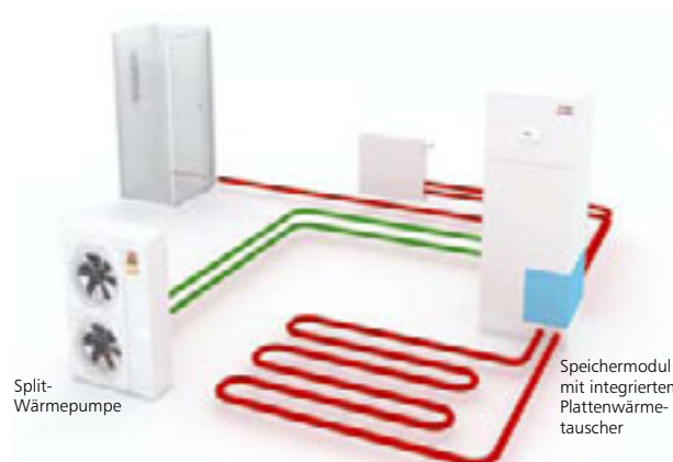
Ecodan Split-Wärmepumpensystem Hier wird das anschlussfertige Innenmodul inklusive Plattenwärmetauscher an das Split-Außengerät angeschlossen. Durch die Verbindung über kältemittelführende Rohrleitungen sind zwischen Wärmepumpe und Innenmodul Wege bis zu 75 Meter kein Problem.
